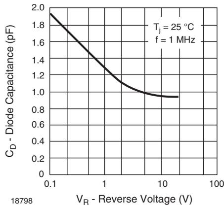
Fig. 1 - Diode Capacitance
